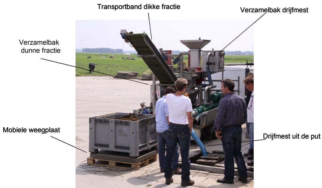
Figuur 2.2. Overzicht van de opstelling met de weeginstallatie voor de dikke fractie.
