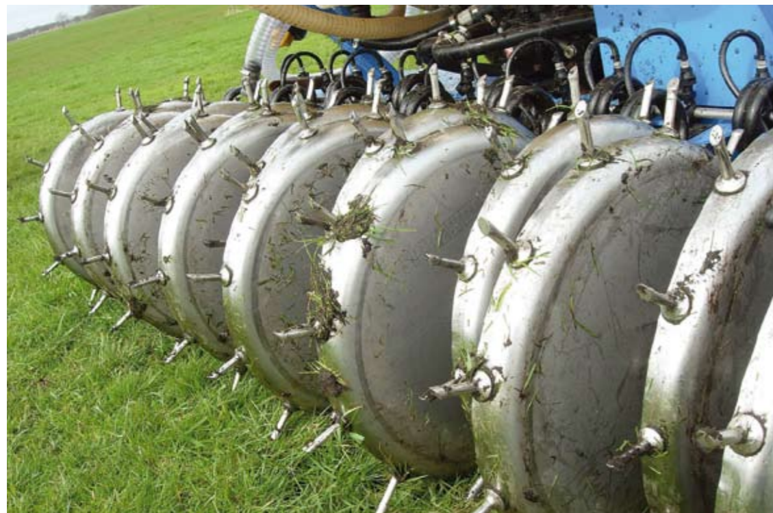
Foto links: Spaakwielbemester voorkomt vervluchtiging. Deze uitvoering (2,3 meter breed) is voor sportvelden (bron: ASG)
