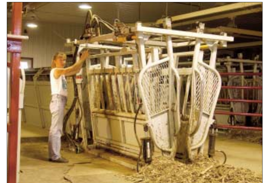
De pneumatische kooi automatiseert het individueel vangen van het vee
