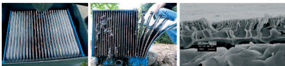
FIGUUR 7: PLAATMEMBRANEN SAMENGEVOEGD TOT ÉÉN MEMBRAANMODULE (RECHTS MICROSCOPISCH BEELD MEMBRAANOPPERVLAK)
