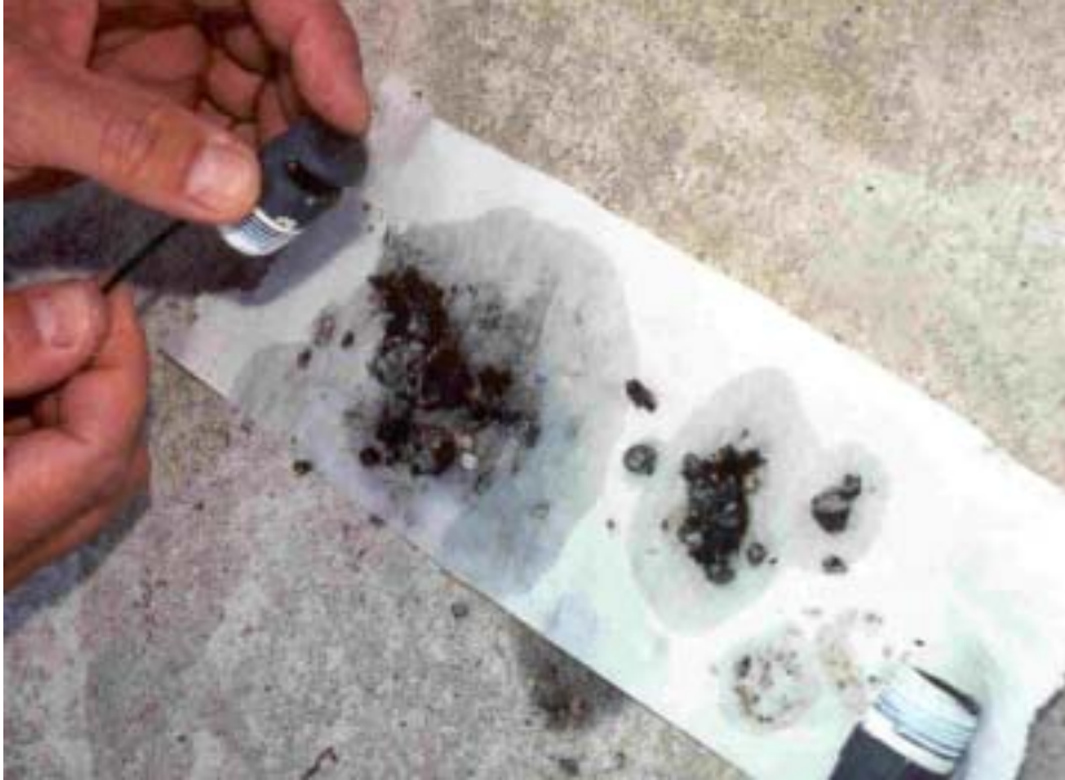
FOTO 2 NOZZELS ZIJN WEDEROM VERVULD.
