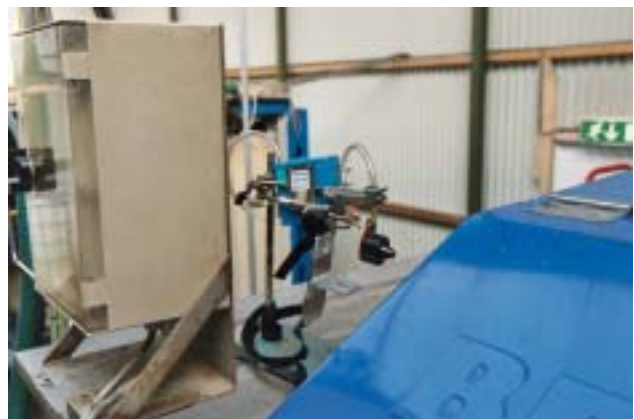
FOTO 7: RUIMTELIJKE METING MET PARALLELE DE CONVENTIONELE EN DE PASSIEVE SAMPLERS (BIJ ZEEFBANDPERS)
