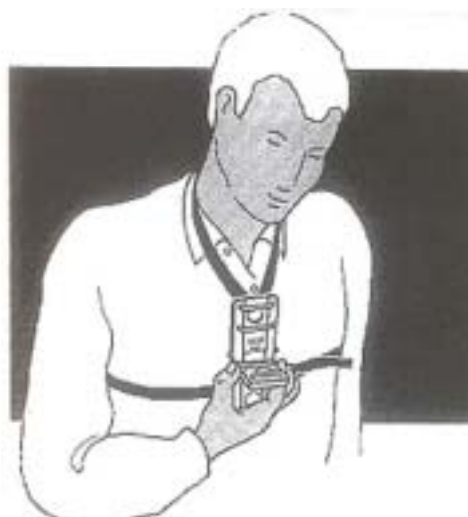
FIGUUR 3 GEBRUIK PASSIEVE MONITOR TIJDENS METINGEN
