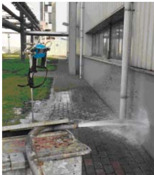
FOTO 13: STATIONAIRE METING, PARALLEL ACTIEVE EN PASSIEVE MONSTERNAME
