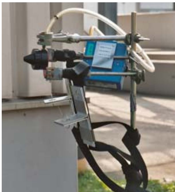
FOTO 12: STATIONAIRE METING, PARALLEL ACTIEVE EN PASSIEVE MONSTERNAME
