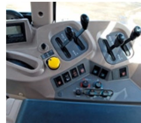
Standaard heeft de M128X twee dubbelwerkende ventielen, twee extra is een optie.
