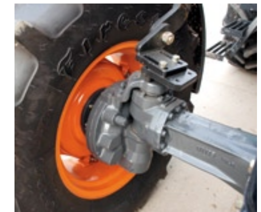
Bi-Speed geeft een prima wendbaarheid door de voorwielen extra te versnellen.
