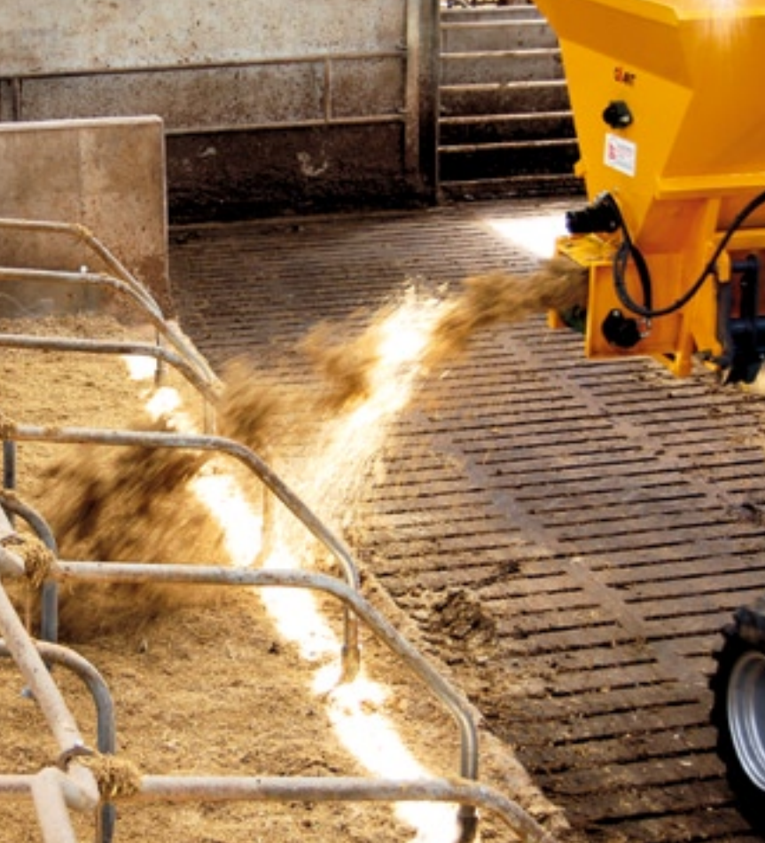
Het kalk-stro-matras is machinaal te verwerken. Een zaagselinstrooier is hiervoor niet geschikt, maar een voerbak voor maïs wel.
