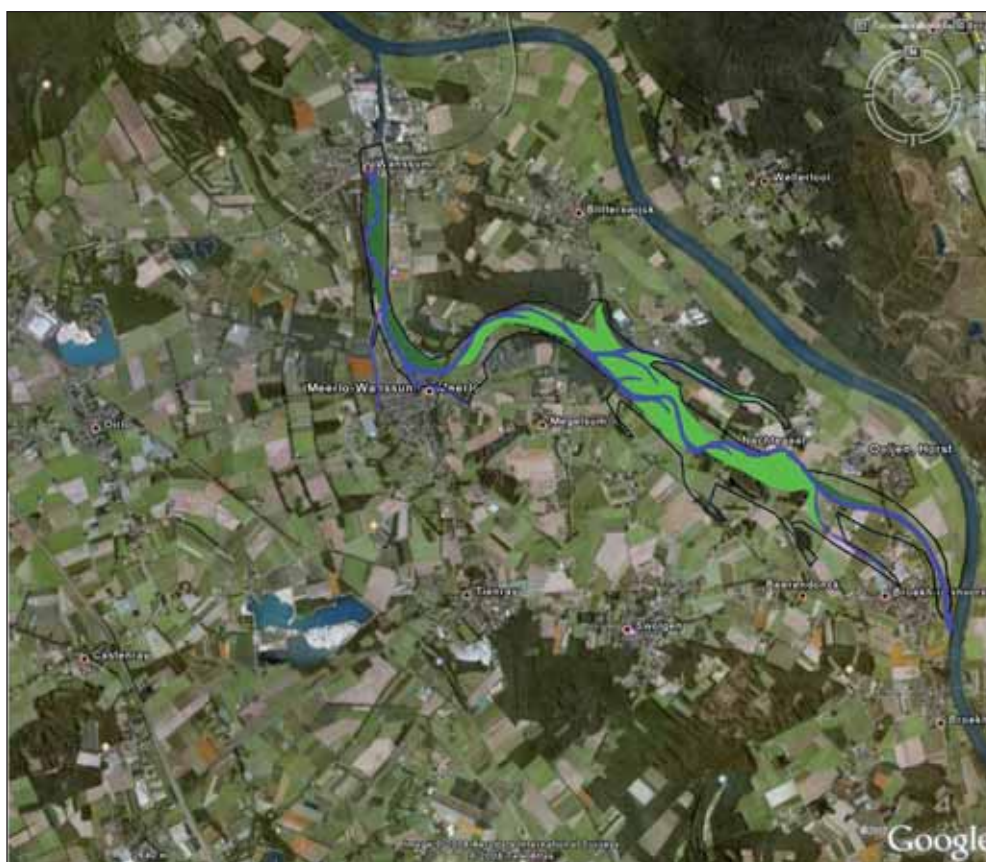
FIGUUR 1 Een nieuwe rivier in de Oude Maasarm. Op grond van dit ontwerp zijn de globale verkenningen uitgevoerd. In blauw de nieuwe bedding, in groen de maaiveldverlaging. De oppervlakte van de maaiveldverlaging bedraagt hier circa 210 hectare. Dit correspondeert ruwweg met de doelstelling voor de ontwikkeling van natte natuur in de Oude Maasarm. Nadere detaillering is nodig.
