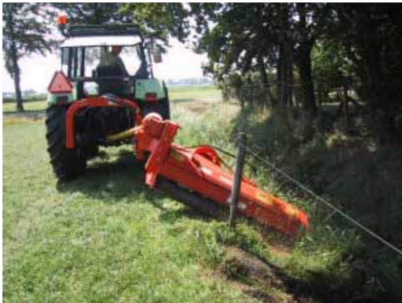
Figuur 6-1 klepelmaaier voor het maaien van droge oeverprofiel
