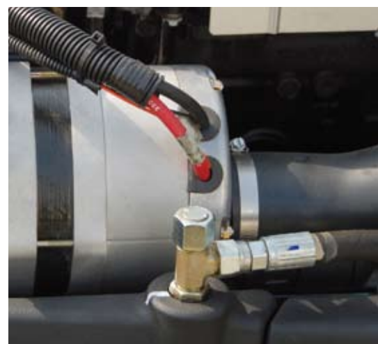
Een 48 Volt dynamo of alternator zorgt voor stroom om de kooien aan te drijven.
