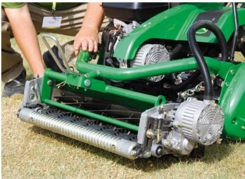
De kooien van de handgreenmaaier zijn zo opgehangen dat ze de grasmat optimaal kunnen volgen.
