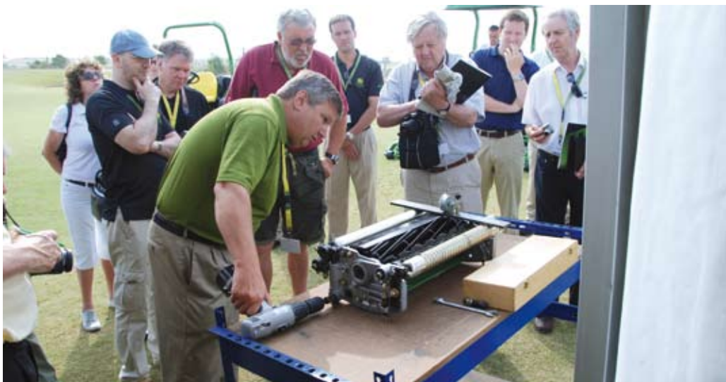
Met een accuboormachine kun je de maaihogte eenvoudig aanpassen.
