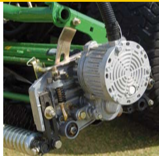
Is dit de toekomst? Geen hydromotoren op de kooi maar elektromotoren.
