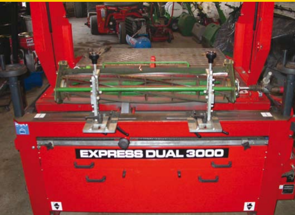
Zo slijpt men rondzels in Engeland, met de 'grinder' (foto: STRI)
