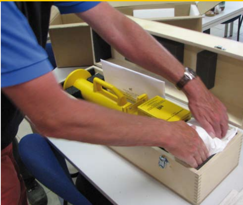
De Cleggmeter van het STRI, gebruikt op de zes banen, wordt uitgepakt voor gebruik.
