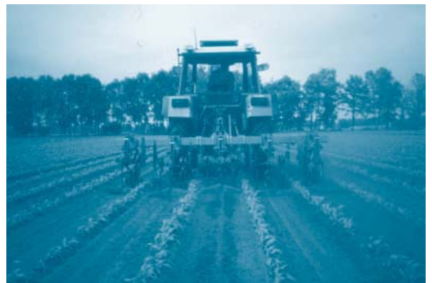
Volledig mechanische onkruidbestrijding in maïs mogelijk met eggen gevolgd door aanaardend schoffelen
