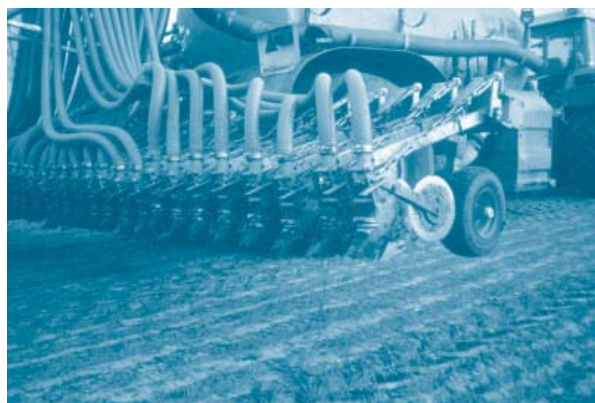
Triticale wordt in het voorjaar bemest met een injecteur met sleufrouter
