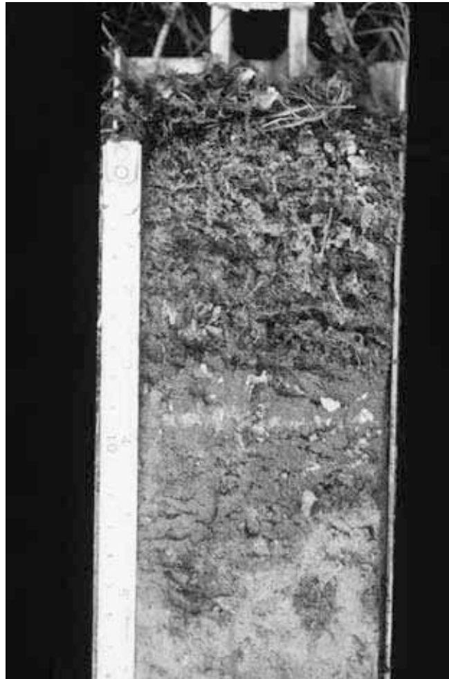
Foto B. Als de zuurgraad daalt en de activiteit van de bodemfauna daardoor vermindert, wordt het organisch (wortel)materiaal niet goed meer omgezet en accumuleert het slecht afgebroken wortelmateriaal.
