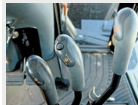
▲ De transmissie heeft een driertraps powershift, 4 gesynchroniseerde versnellingen, 3 groepen en een gesynchroniseerde voor-achterruit.
