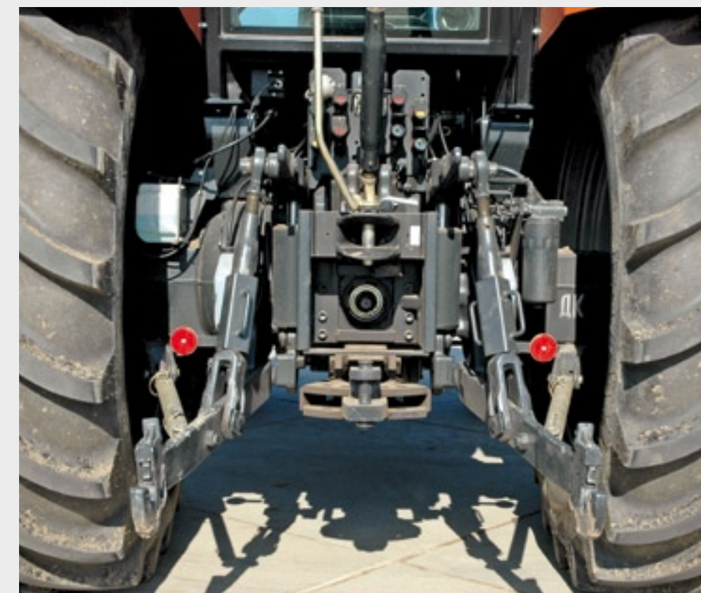
▲ De achterkant is robuust uitgevoerd en biedt voor het gangbare werk voldoende hefkracht. De aftakas heeft standaard 540/1000 en als optie economy-versies. Die zijn aan te bevelen.
