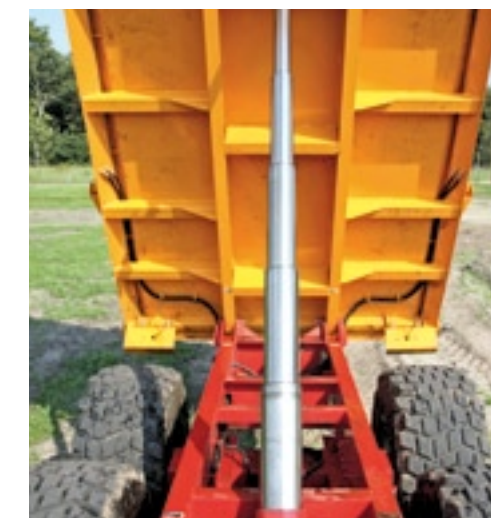
▲ De grotere kiepcilinder zorgt voor genoeg tilkracht.
