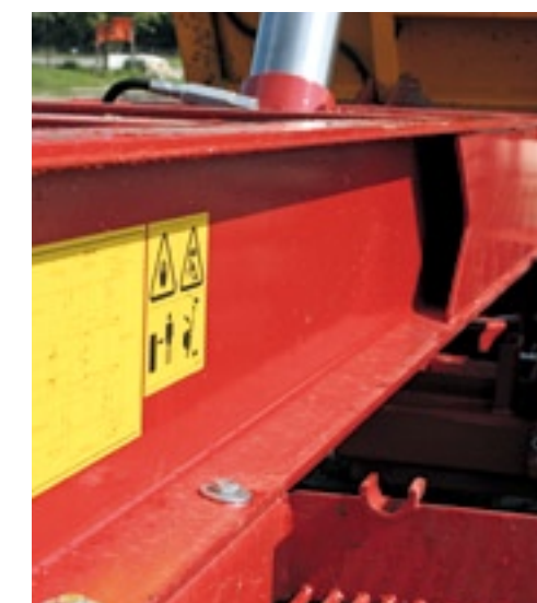
▲ Het U-profiel van het chassis is groter dan bij een landbouwkipper.
