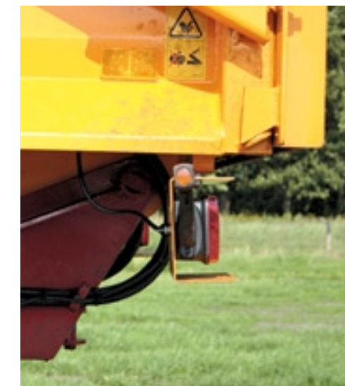
▲ De verlichting zit standaard aan de kipper en staat ver naar achteren.
