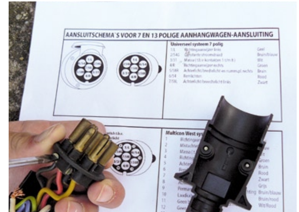
Geel, blauw, bruin, rood, wit, zwart, groen. Een stekker van de verlichting van een aanhanger heeft heel wat draden. Het schema is in het instructieboek geeft aan welke draadkleur wat is.
