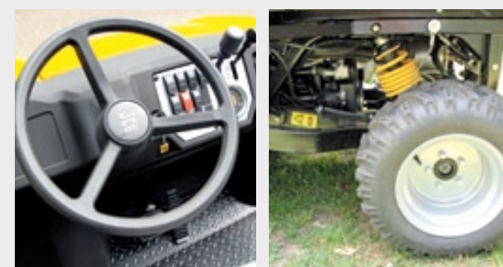
Het stuurwiel van de Groundhog is niet verstelbaar; het clustertje schakelaars vergt enige bestudering. De achterwielen zitten aan een lengte-arm; de banden hoeven dan tijdens het veren geen zijdelingse krachten op te vangen.
