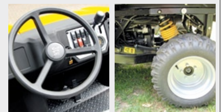
Het stuurwiel van de Groundhog is niet verstelbaar; het clustertje schakelaars vergt enige bestudering. De achterwielen zitten aan een lengte-arm; de banden hoeven dan tijdens het veren geen zijdelingse krachten op te vangen.
