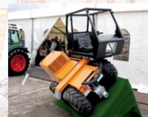
Het Duitse Lipco lanceerde de JR GT taludwerktuigen-drager. Speciaal is de verstelbare cabine die altijd horizontaal blijft. De cabine schuift over een rail en is ook 180 graden draaibaar. Dit geeft comfort en tegengewicht. Een nadeel kan zijn dat je het gevoel verliest hoe steil de helling is. De 17 kW (22 pk) B&S motor is pendelend opgehangen. Aandrijving gebeurt via vier hydromotoren in elk wiel waarmee tot 18 km/h te rijden is. In de hef kan 600 kg. De wielbasis is traploos van 70 naar 130 cm verstelbaar. De breedte is 100 cm en het gewicht 620 kg.
