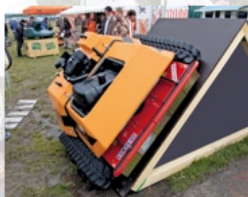
Voor het maaien van steile taluds toonde Komtek de Roboflail met afstandsbediening. Deze taludmaaier kan hellingen aan tot 55 graden. Tussen de Niko rupsen kan een cirkeldek of klepelmaaier van 122 cm breed. De aandrijving is door een 19 kW (25 pk) Kawasaki motor met olie- en benzinepomp die de steile taluds aankunnen. De 30 liter grote brandstoftank beweegt automatisch met de helling mee. Hij kan 10 km/h en is tot 300 meter afstand te bedienen. Het gewicht is 650 kg en de prijs 28.000 euro exclusief btw.
