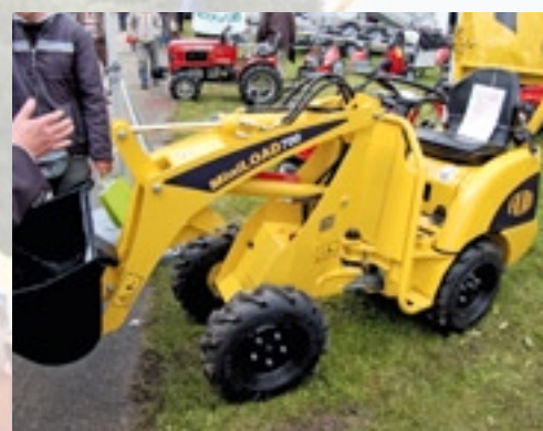
Van Fiori was de nieuwe Miniload 700 te zien. Dit is de opvolger van de Miniload 600. De ML700 heeft vooral een nieuw design. Verder is de Lombardini vervangen door een Kubota diesel van 18 kW (25 pk) en is de beschermbeugel nu klapbaar. De minishovel is op zijn smalst 76 cm breed waardoor je er gemakkelijk mee door poorten en deuren kan. De laadhoogte is 256 cm, hij kan 300 kg heffen en heeft een draaistraal van 195 cm. Het gewicht is 800 kg.
