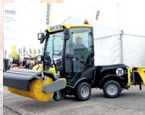
Kärcher lanceerde zijn eerste werktuigen-drager, de MC 50. Deze is knikgestuurd. Basisprincipe is de functie als veegzuig-machine met standaard een watertank van 170 liter. Achterop kan bijvoorbeeld een zoutstrooier. Er zijn twee typen: de Classic is een echte veegmachine met een 14,6 kW (20 pk) dieselmotor en voorwielaandrijving, de Advance heeft een 19,2 kW (26 pk) diesel met vierwielaandrijving. Hier kan ook een sneeuwschuiver of maaidek aan. Beide typen kunnen 20 km/h. De machine is 109 cm breed en heeft een draaicirkel van slechts 70 cm. Hij weegt zo'n 1.100 kg.
