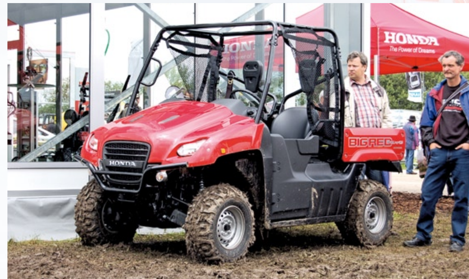
Honda Europe liet een proefballon op om te kijken of zijn transporter ook in Europa aanslaat. Met de Bigred kon je een proefrit maken over een modderparcours. Honda maakt de transporter in Mexico voor de Amerikaanse markt en is er alleen met een benzinemotor van 23 kW (32 pk). In de laadbak, standaard handmatig te kippen, kan 227 kg. Het koppel is 50 Nm en het trekvermogen 544 kg. Zowel achter als voor is er een differentieel. De hydrostaat met bandaandrijving heeft drie groepen waarmee je 70 km/h kunt halen. In de tank kan 30 liter benzine. De prijs is ongeveer 15.000 euro.
