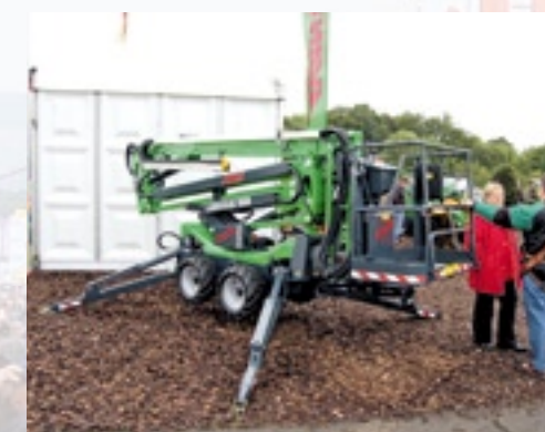
Bij Avant op de stand stond een nieuwe compacte hoogwerker. Deze wordt gemaakt door Leguan, dat onder de Finse Avant Group valt. Het platform van de Leguan 160 kan 13,6 meter hoog, waardoor je ongeveer tot 15,6 meter hoog kunt werken. De transportbreedte is 125 cm. Hij is er met banden en rupsen en uit te rusten met een 13 pk Honda benzine-, 14 pk Kubota diesel- of met een elektromotor waarmee je tot 4,5 km/h kunt rijden. De Leguan weegt 1.900 kg en kost circa 48.000 euro.
