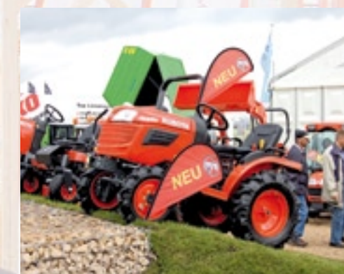
Kubota lanceerde de nieuwe B-20 serie. Dit is het nieuwe instapmodel. Er zijn drie typen, de B1220 compacttrekker is de kleinste. Deze heeft een 9 kW (12 pk) tweecilinder diesel, continu 4wd, zes versnellingen vooruit en twee achteruit, met een maximumsnelheid van 18 km/h, driepuntshef en een hefvermogen van 430 kg. De B1220 weegt 460 kg en is te koop vanaf 8.200 euro exclusief btw. Optioneel is onder andere een maaidek van 125 cm, hydraulische aansluitingen en gazonbanden. Verder zijn er de B1620 (16 pk) en 1820 (18 pk). Hiervoor is een voorlader beschikbaar met een hefvermogen van 300 kg. Deze modellen hebben standaard een enkelwerkend ventiel. ■
