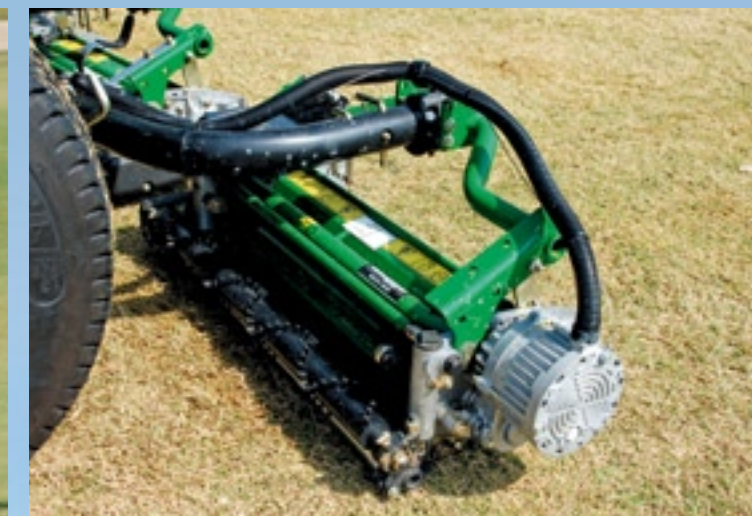
Speciaal aan de nieuwe QA maaikooien (Quick Adjust) is dat je de maaihoogte van één zijde snel kunt instellen met een accuboormachine. Beide zijden van de achterrollen zijn met elkaar verbonden via een spindel. Via stelknoppen is de afstelling van het ondermes naar de kooi aan te passen.
