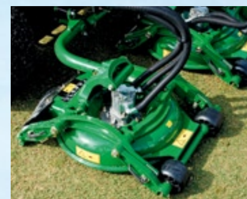
Ook is er een nieuwe vijfdelige cirkelmaaier met bodemvolgende maaideks: de 8800. Hierbij is de maaihoogte snel in te stellen van 2,5 tot 10 cm in stappen van 0,6 cm.
