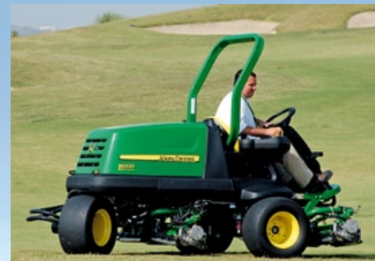
De 8000 E-Cut driewielige fairwaymaaier heeft een hybride aandrijving en is door het ene achterwiel erg wendbaar. Door de elektrische kooiaandrijving is er geen oliekkage. De motor draait op laag toerental. Dit geeft 2 dB(A) minder geluid en tot 12 procent brandstofbesparing, weet de fabrikant.
