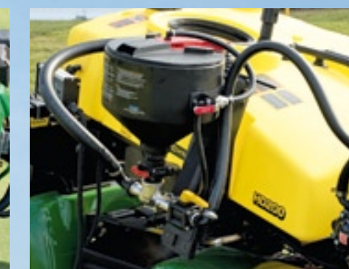
De HD200 Selectspray is zonder gereedschap op een ProGator transporter op te bouwen. Handig is een optionele vultank voor spuitmiddelen die je tot heuphoogte kunt laten zakken.
