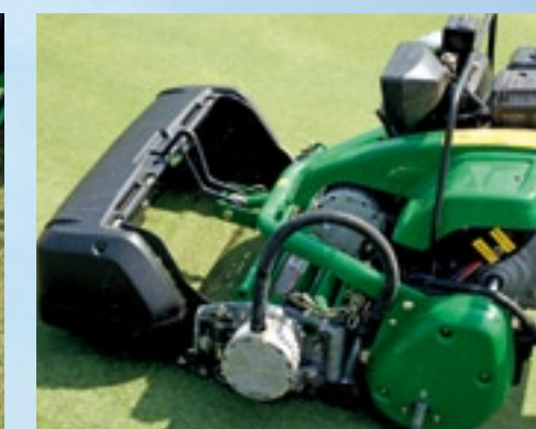
De 220 E-cut hybride handgreenmaaier heeft een getrokken pendelende kooi. De motor drijft, naast de dynamo, de achterwals aan. De opvangbak rust op het chassis.
