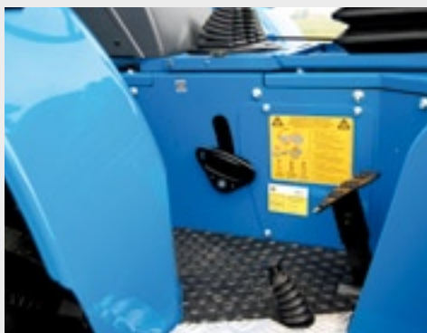
De handrem, in oliebad, is netjes weggewerkt aan de rechterkant van de tunnelbak.
