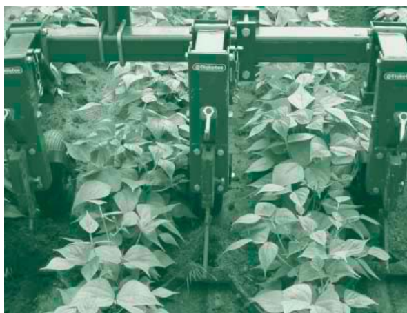
Rijenbespuiting in combinatie met aanaardend schoffelen is een optie voor onkruidbestrijding in stamslabonen
