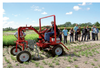
Compacte zelfrijdende machine met bewegbare schoffels en bewegbare wiedepp
