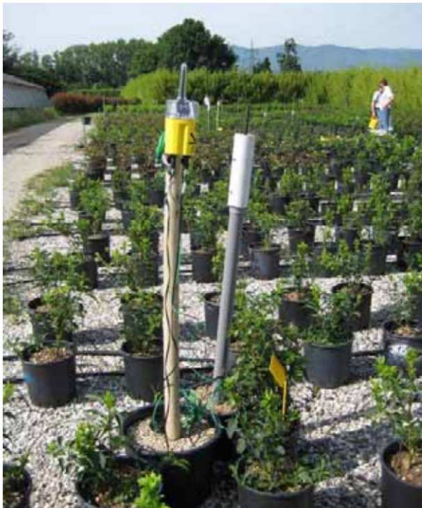
Abbildung 3.1 Drahtloses Sensornetzwerk in der Versuchsanstalt Ce.spe.vi für Baumschule in der Toskana, Italien
