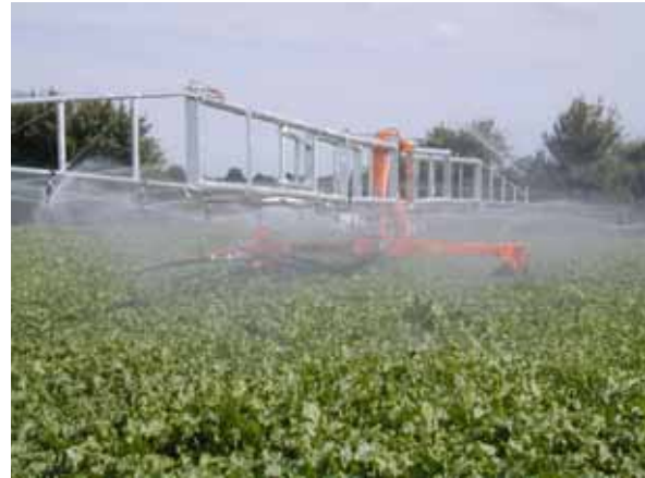
Abbildung 1 Düsenwagen in Verbindung mit einer mobilen Beregnungsmaschine zur besseren Wasserverteilung
