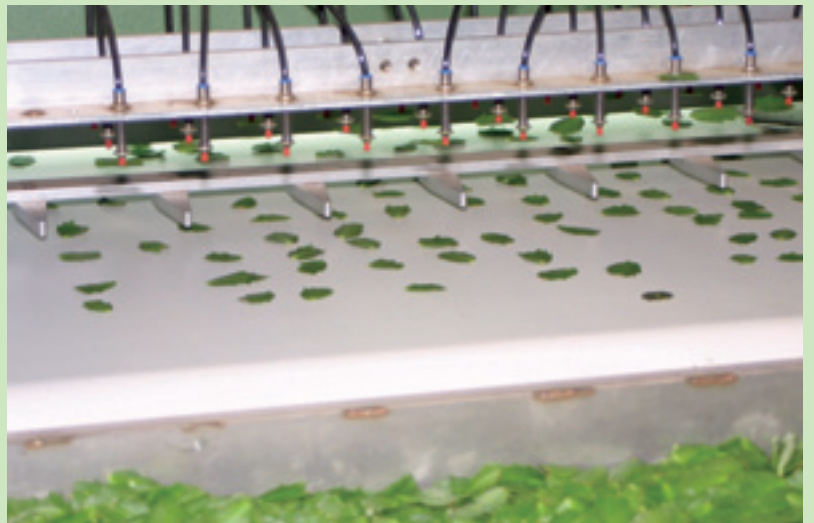
De lidcactusstekken worden verenkeld: grijpers met zuignappen pakken stekjes uit de voorraadbak (voorgond) en leggen deze op de leesband voor de camerasorteerder.
