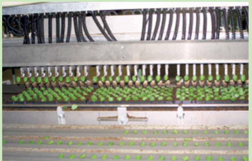
Minispaden steken de sleuven voor de stekken, die klaarhangen om gestoken te worden. In deze fase raken de zuignappen van de steekunit nog te snel vervuild, wat stilstand veroorzaakt.
