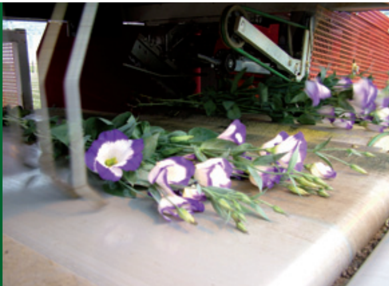
De machine voegt 2 bossen van vijf stuks samen tot 1 bos; knipt de bos af en bindt deze.
