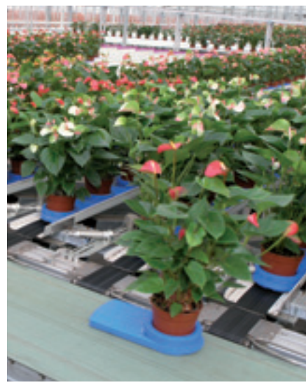
Bij RijnPlant worden bij afleveren de gewenste sorteringen en kleuren door het systeem bij elkaar gezet.
