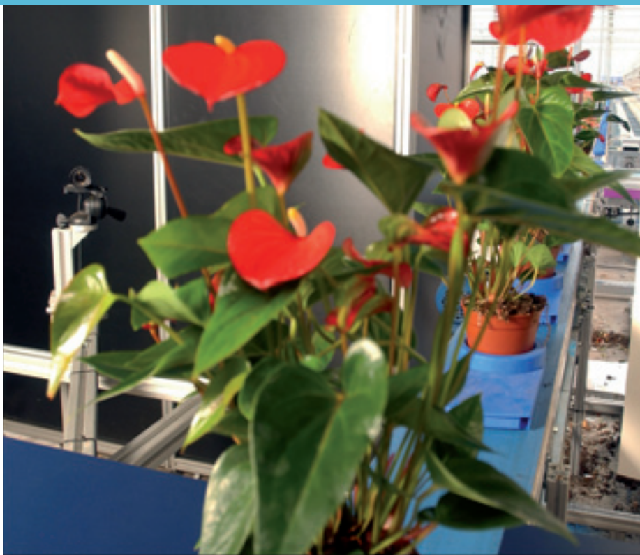
Bij RijnPlant meten vijf camera's de plantlengte, het aantal bloeiende bloemen en het bladoppervlak voordat de planten naar de verwerkingsruimte gaan. Deze gegevens worden in de plantendrager opgeslagen (foto RijnPlant).
