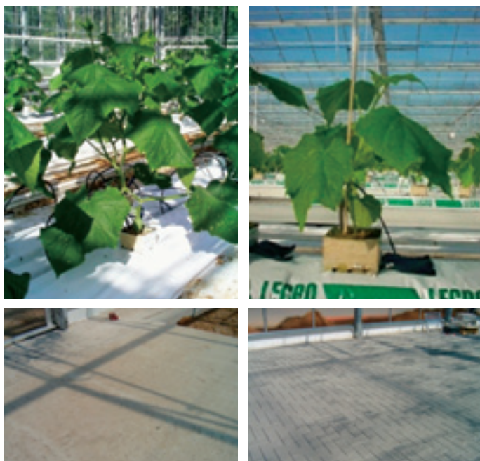
Een diffuus kasdek materiaal leidt tot een regelmatigere lichtverdeling in de kas. Links: Slagschaduw door helder floatglas; rechts: minder schaduw door meer diffuus licht.
