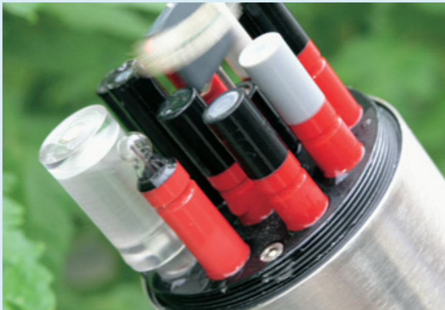
De teler heeft met de Hydrion-10 de volgende tien meetwaarden in zijn bezit: temperatuur, EC, pH, kalium, natrium, calcium, ammonium, chloride, nitraat en carbonaat.
