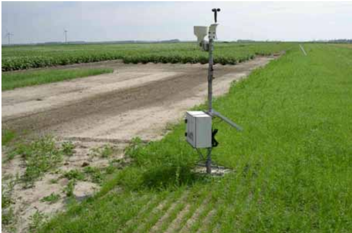
Figuur 3.3.1. Weerpaal voor het verkrijgen van weersgegevens voor BOS-sen.
