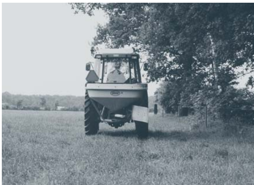
De kantenstrooi-inrichting zorgt ervoor dat er een kunstmest in de sloot of buiten het perceel terecht komt.
