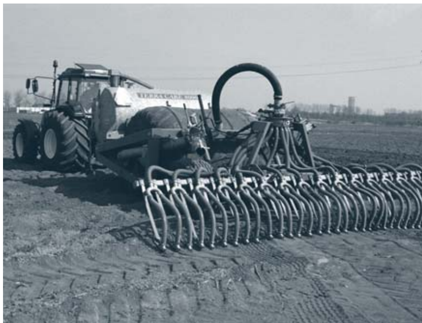
Sleepvoetmachine. Mestinjectie op grasland komt de laatste jaren vrijwel niet meer voor. Veehouders zijn geleide- lijk overgegaan op zogenoemde tweede- generatietechnieken, zoals zodenbemesting en werken met de sleepvoetmachine.
