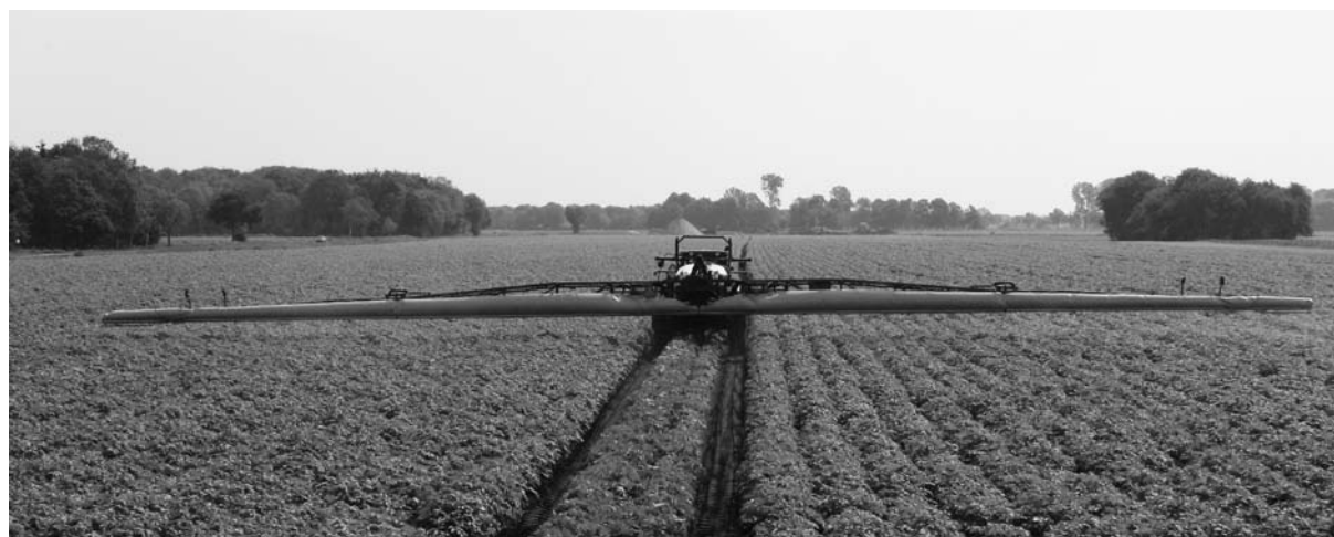
Figuur 3. Spuit met luchtondersteuning in actie in een aardappelperceel.
