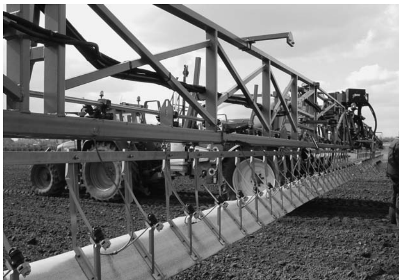
Figuur 2. Spuit met sleepdoekstelsysteem.
