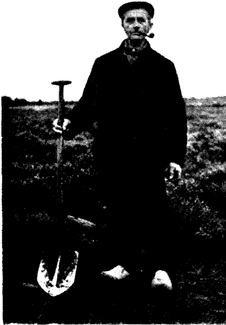
Fig. 4. De plaggenschop, z.g. vijfhoek, gebruikt in de omgeving van Dallsen. A shovel, so-called pentagon, used for sod-cutting.
