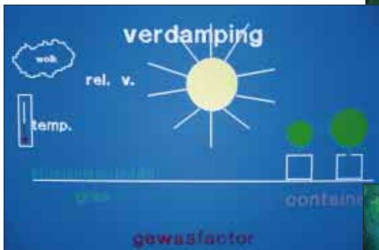
Schematische weergave van de factoren die belangrijk zijn voor de sturing van het automatisch watergeven.
