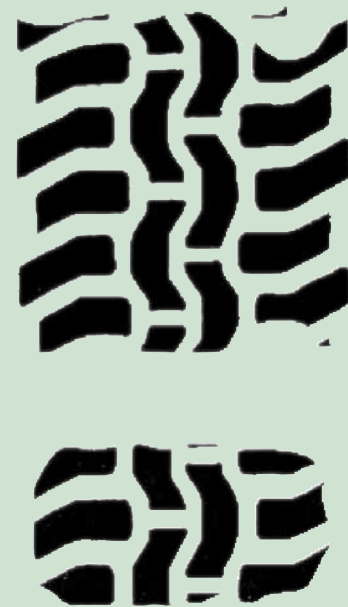
Een zachte band heeft een veel groter contactoppervlak met de grond dan een harde band (belasting van 2300 kg op betonbaan, bandtype: 18R22,5)
