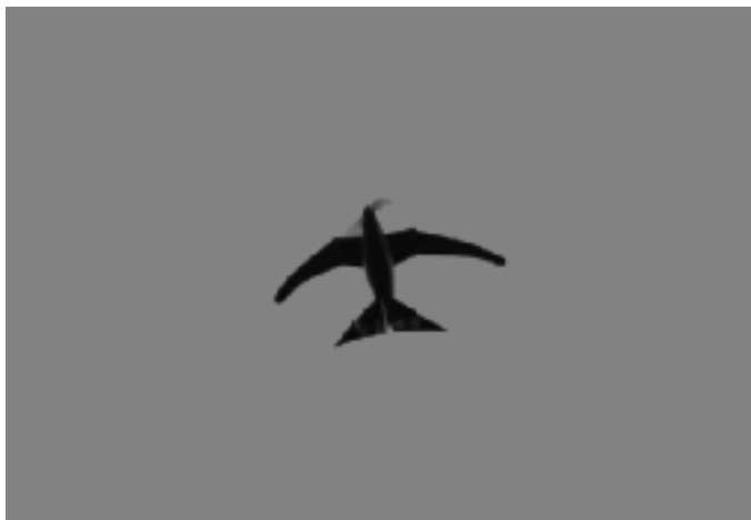
Figuur 1: De RoboSwift met variabele vleugelstand
