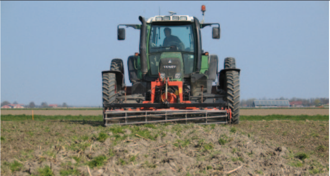
Trekker met aangepaste spoorbreedte (3,15m) voor BASIS.
