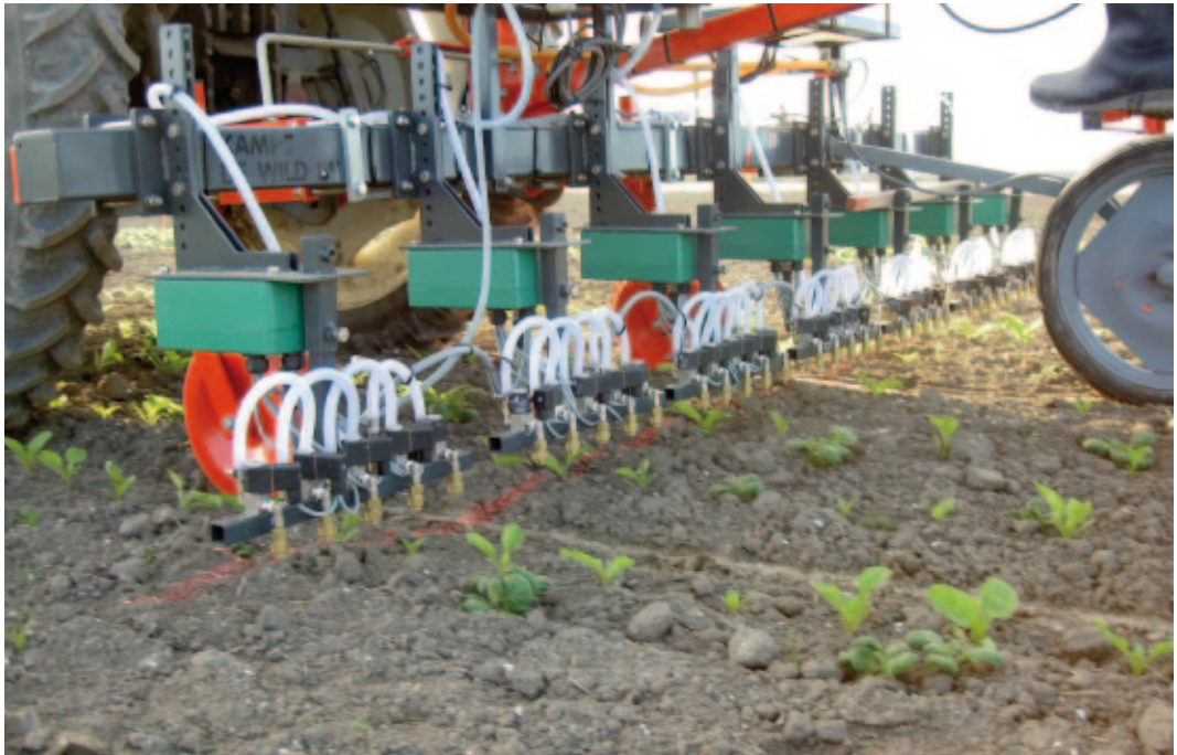
De Weed IT kan met fluorescentiesensoren aardappelopslag tussen de bieten rijen bestrijden.
