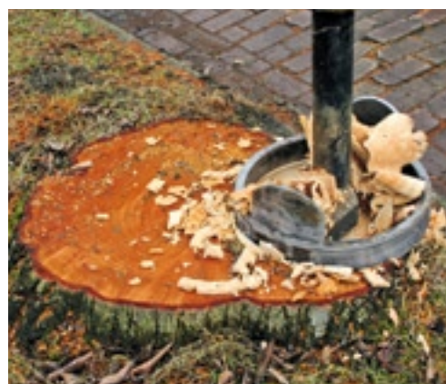
De stobbenboor maakt hapklare brokken van de stobbe, die je makkelijk kunt opruimen.
