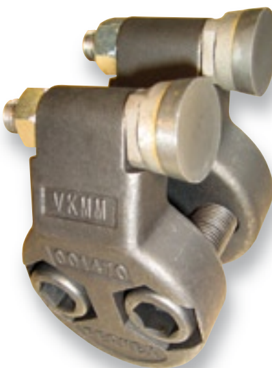
Vaak zijn er op een freeswiel verschillende soorten beitels te monteren. Ronde beitels, zoals deze van Fermex, zijn in drie posities te verzetten om ze rondom te verslijten.
