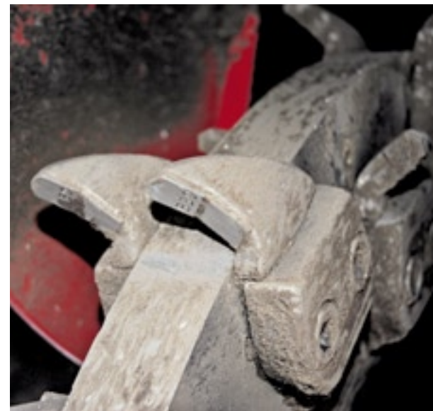
Ufkes werkt met smalle beitels, een links en rechts gebogen en een rechte beitel, voorzien van widiaplaatjes. Een tweede plaatje voorkomt dat de steel van de beitel doorslijt.
