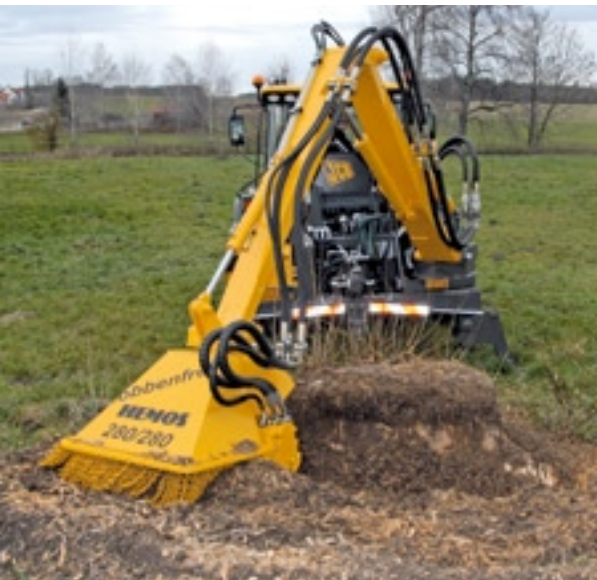
De zwaarste stobbenfreesen worden via een aftakas aangedreven pomp, hydraulisch aangedreven. Een lange giek met groot zwenkbereik is alleen te realiseren met een hydraulische aandrijving.
