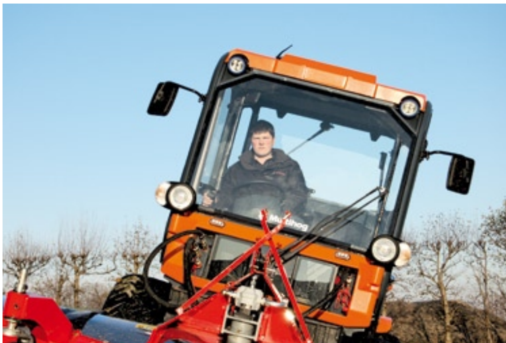
Speciaal is de optionele stoel in de cabine. Deze kan automatisch 20 graden naar rechts en links kantelen zodat de chauffeur op hellingen recht op zijn stoel blijft zitten.
