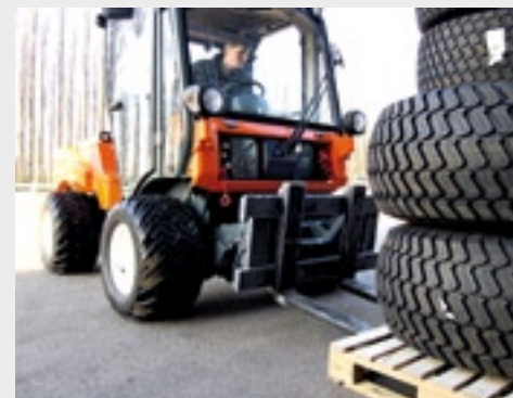
Met een palletvork kan de Multihog 2 ton tussen de lepels tillen. Op 60 cm is dit 1,2 ton.
