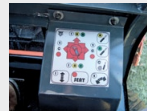
Joystick schema. Via een kleurknopje en de kruishendel te bewegen bedien je alle hydraulische functies inclusief de stoelzilverstelling.
