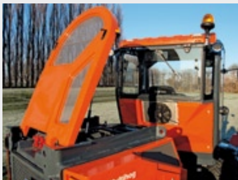
Achterop is een chassis aanwezig voor opbouw mogelijkheden van bijvoorbeeld een zoutstrooier of watertank.
