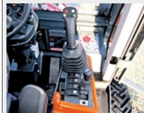
Op de rechterarmleuning zit de joystick voor de hydrauliek, gashendel, rijrichting en schakelaars voor differentieel, aftakas en rem.
