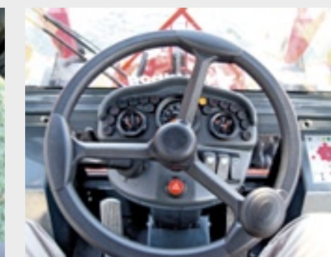
Het dashboard met meters, ledlampjes en schakelaars. Rechtsomzet zit de schakelaar voor de twee hydrostaatgroepen.
