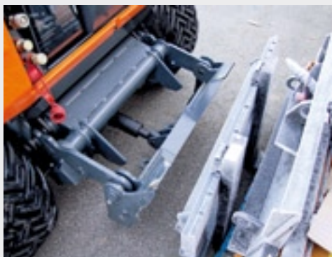
Het snelkoppelframe van de fronthef. Vergrendelen is via een pen met splitpen.
