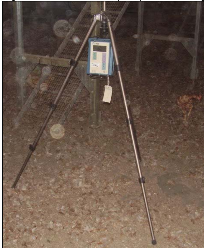
Figuur 8 Meetopstelling met de DustTrak aan de driepoot op de onderste etage
