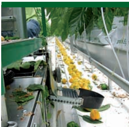
De oogsters leggen de gesneden vruchten op de kleppen van een elevator, die de vruchten naar beneden brengt en opzij afvoert naar de sleepband.
