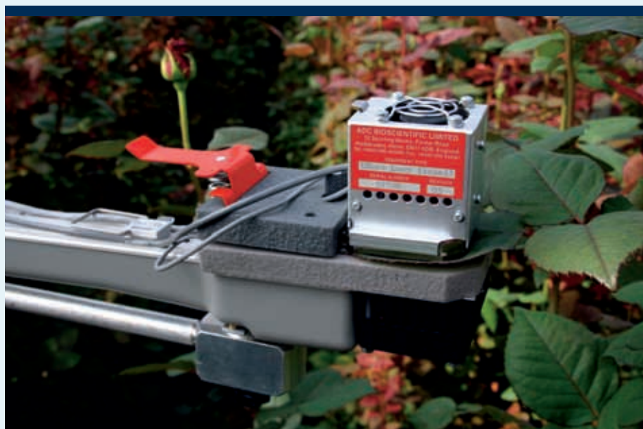
Anja Dieleman gaat aan de hand van 24-uurs metingen van de fotosynthese van één blad kijken wat het meest efficiënte belichtingsschema is.
