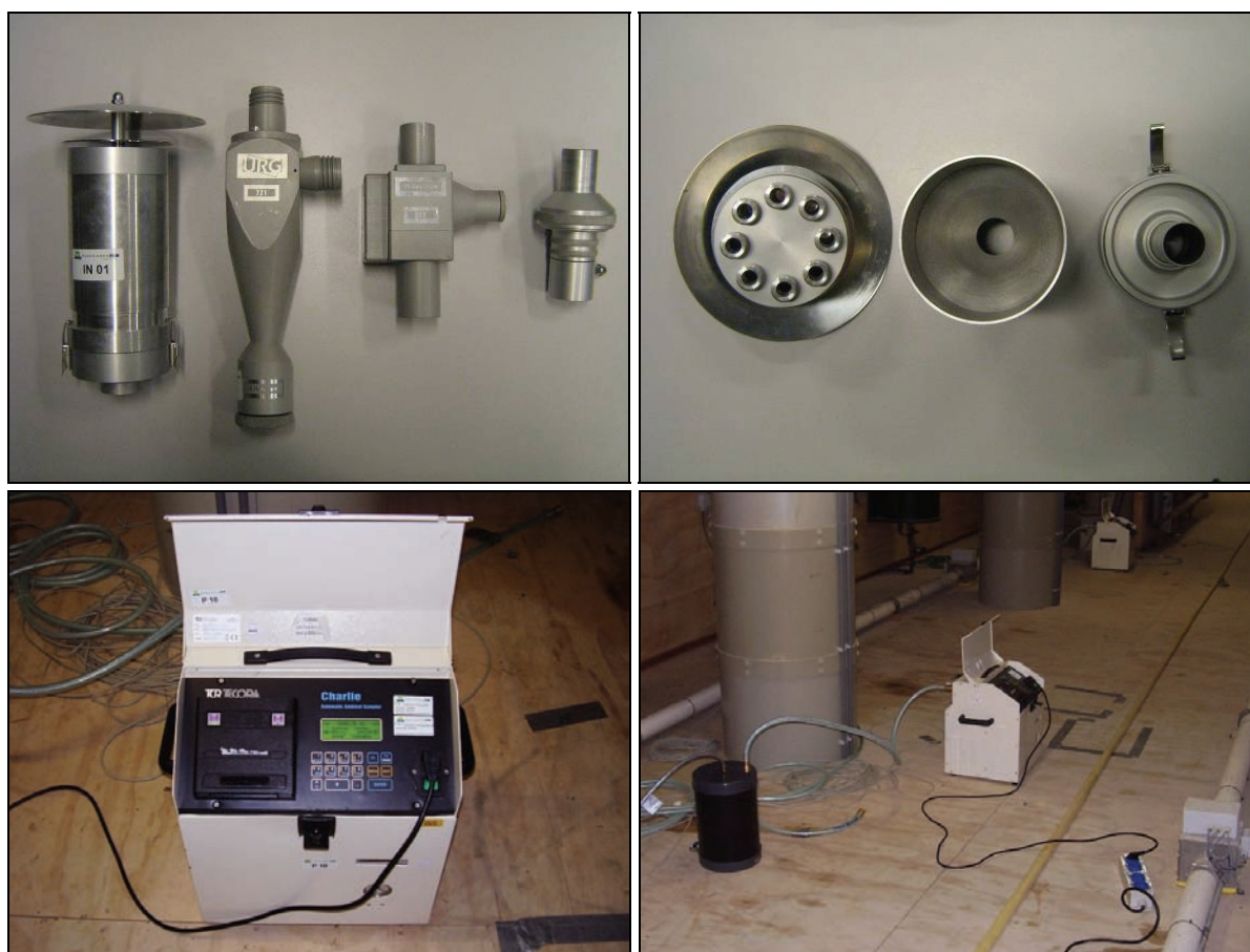
Figuur 5 Monsterapparatuur voor PM10 en PM2,5. Linksonder (van links naar rechts): de inlaat, de PM10 cycloon, de PM2,5 cycloon en de filterhouder. Rechtsboven: de constructie van de inlaat van de cycloon. Linksonder: de 'constant flow' pomp. Rechtsboven: de pomp met aangesloten vochtvanger
