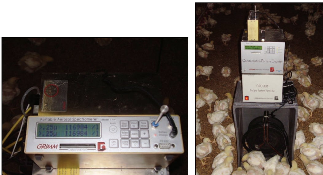
Figuur 7 Links: de Portable Aerosol Spectrometer (PAS). Rechts: de Condensation Particle Counter (CPC), geplaatst op het CPC Air Supply System. Daarbovenop staat de Portable Aerosol Spectrometer
