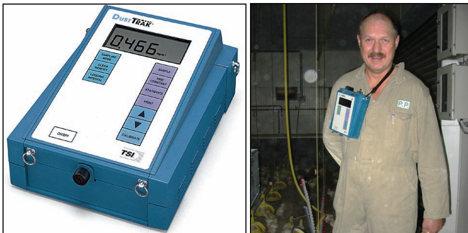
Figuur 6 Links: de DustTrak model 8520. Rechts: het meten van de persoonlijke stofbelasting
