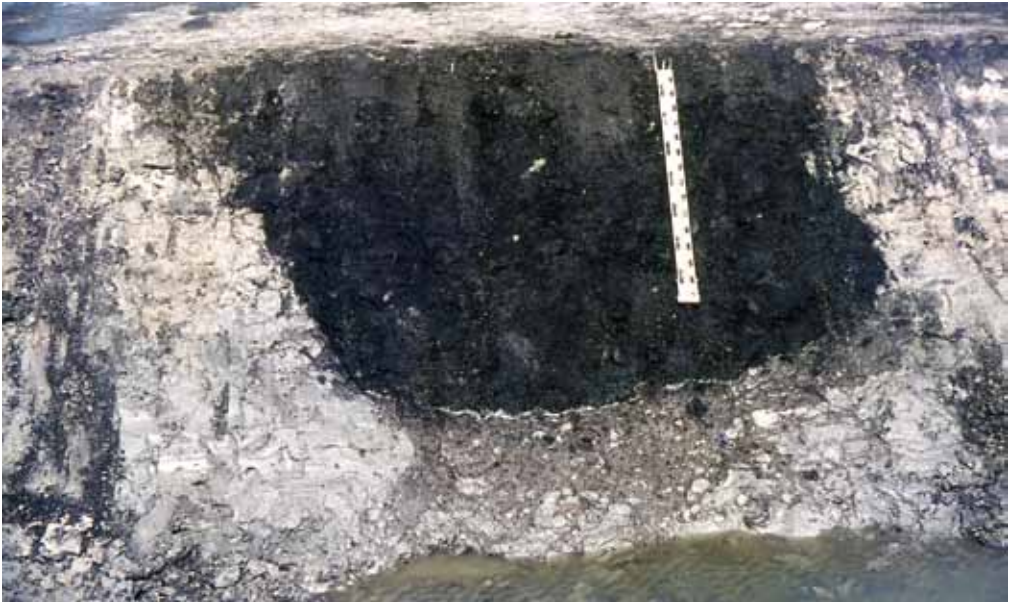
Figuur 1: Profiel van een daliegat (circa 2,5 meter) in een slootwand van de polder Ursem. Onder het veen komt een baggerachtig mengsel van klei en veenresten voor (foto: Louis W. Dekker).
