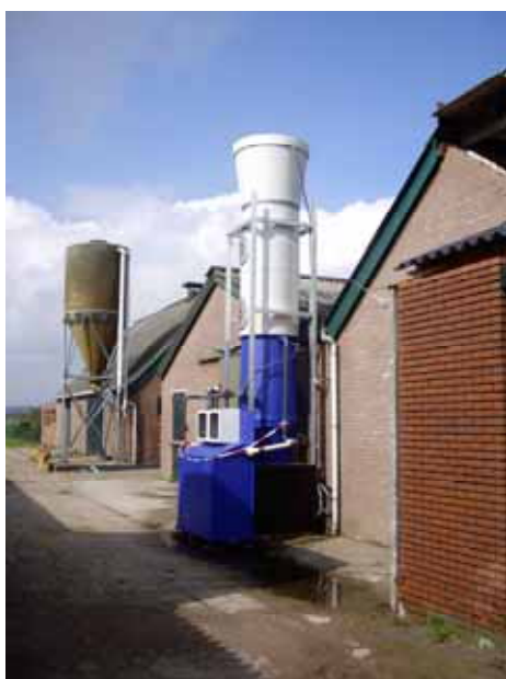
Foto: Prototype luchtwasser die achter de kelderluchtafzuiginstallatie werd opgesteld (luchtwassysteem heeft blauwe onderzijde en witte bovenzijde).
