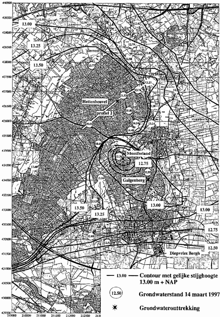
Figuur 3: Gemeten grondwaterstanden en isohypsenpatroon WVP1.
