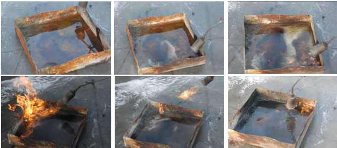
Figuur 29 Van links naar rechts: koolzaadolie in een bak, die eerst werd opgewarmd, vervolgens verdampte er olie. Deze damp ondersteunde een vlam maar kon geen vlam in stand houden. Zodra de gasbrander weg was, verdween de vlam.
