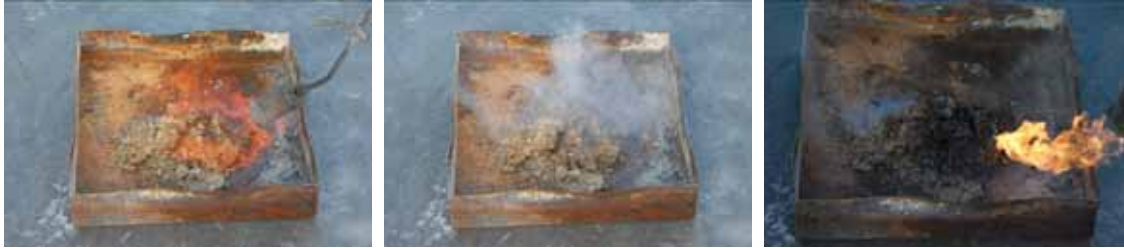
Figuur 30 Verbranding van mest van Het Spelderholt waar geen koolzaadolie was verneveld
