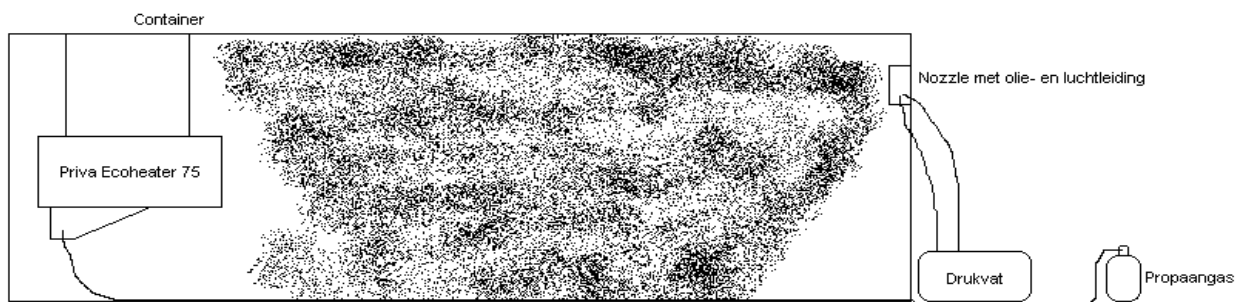
Figuur 6 Container waarin de brandproef werd gedaan met de locatie van de nozzle en van het warmtekanon. Het gestippelde oppervlak geeft een indicatie van de olienevel. De olienevel vulde de gehele container. De heater is in dit onderzoek vervangen door een vuurkorf en een gasbrander.
