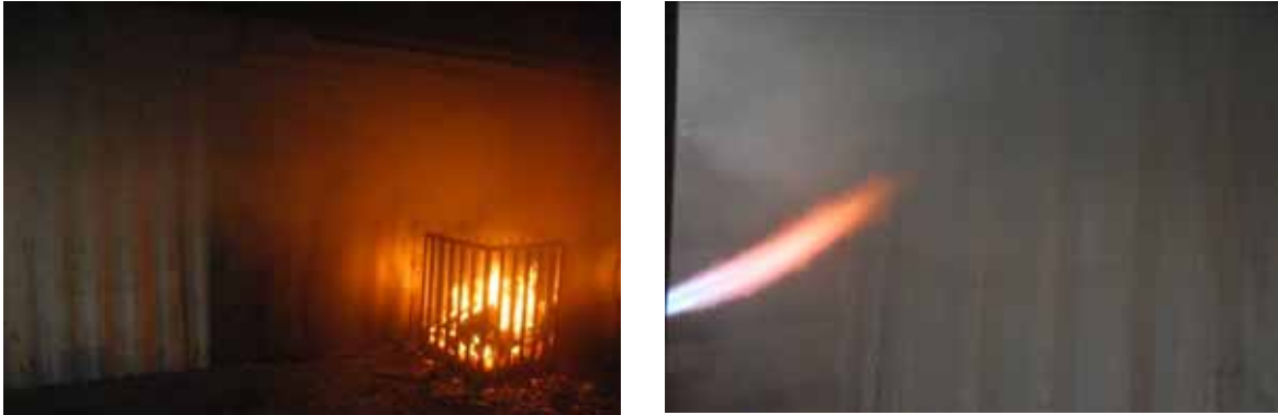
Figuur 28 Foto links: vuurkorf met open vuur. Foto rechts: links op de foto werd koolzaadolie verneveld, met behulp van een gasbrander werd een vlam midden in de koolzaadolienevel gehouden. In beide situaties ontbrandde de koolzaadolienevel niet; ook ondersteunde de koolzaadolienevel in beide situaties geen vlam.
