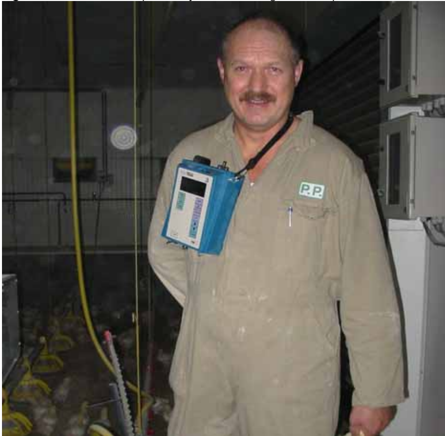
Figuur 5 Meten van de persoonlijke stofbelasting met behulp van de DustTrak
