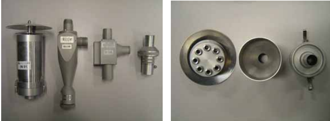
Figuur 4 Monsterapparatuur voor PM10 en PM2,5. De linkerfoto laat de inlaat, de PM10 en PM2.5 cyclonen en de filterhouder zien (van links naar rechts). De rechterfoto laat de constructie van de inlaat zien.
